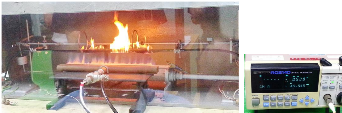
ภาพประกอบที่ 20. ทดลองเผาสายเคเบิล OFC ต้นแบบตามมาตรฐาน IEC 60331-21
