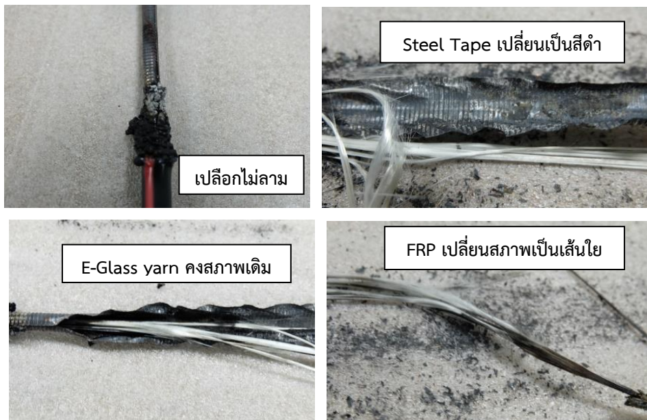
ภาพประกอบที่ 12. ฝ้ายเคเบิล OFC ต้นแบบ SFO เพื่อตรวจสอบและวิเคราะห์ความเสียหายภายใน
