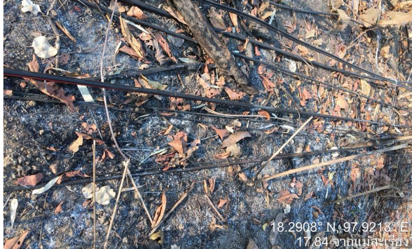
ภาพประกอบที่ 28. สาย FRSS OFC เส้นทาง “แม่สะเรียง-แม่ลาน้อย” ที่โดนไฟไหม้จุดแรก
