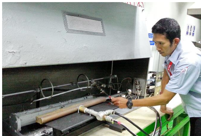
ภาพประกอบที่ 21. ทดลองเคาะสายเคเบิล OFC ต้นแบบหลังทดสอบตามมาตรฐาน IEC 60331-21
