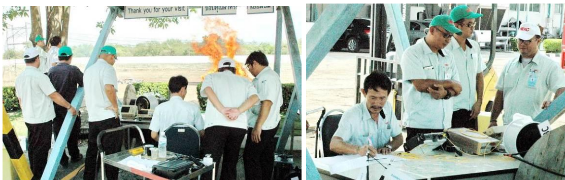
ภาพประกอบที่ 15. มีการเผาสิ่งเกิดและบันทึกค่าทางแสงตลอดการทดสอบ
