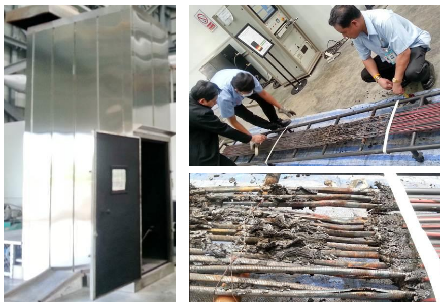
ภาพประกอบที่ 8. ทดสอบสายต้นแบบ SFO การเผาไหม้แนวตั้ง ณ โรงงาน CTW
