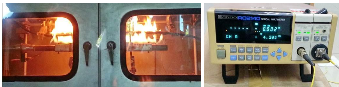
ภาพประกอบที่ 9. ทดสอบสายต้นแบบ HBC การเผาไหม้แนวระดับ ณ โรงงาน BCC
