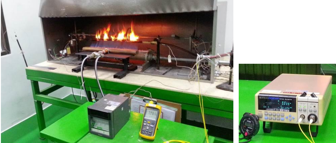
ภาพประกอบที่ 11. ทดสอบสายต้นแบบ SFO การเผาไหม้แนวระดับ ณ โรงงาน CTW
