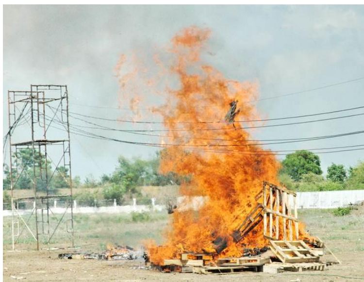
ภาพประกอบที่ 16. ไฟหนัก เชื้อเพลิงโหมโดนสายเคเบิล OFC ตัวอย่างทดสอบสภาพคล้ายปัญหาจริง
