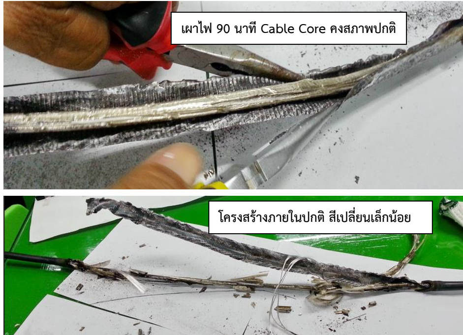
ภาพประกอบที่ 22. ผ่าวิเคราะห์โครงสร้างภายในของสายเคเบิล OFC ต้นแบบ
