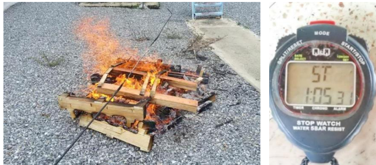
ภาพประกอบที่ 19. ทดลองเผาสายเคเบิล OFC ต้นแบบด้วยเปลวไฟต่อเนื่อง 65 นาที
